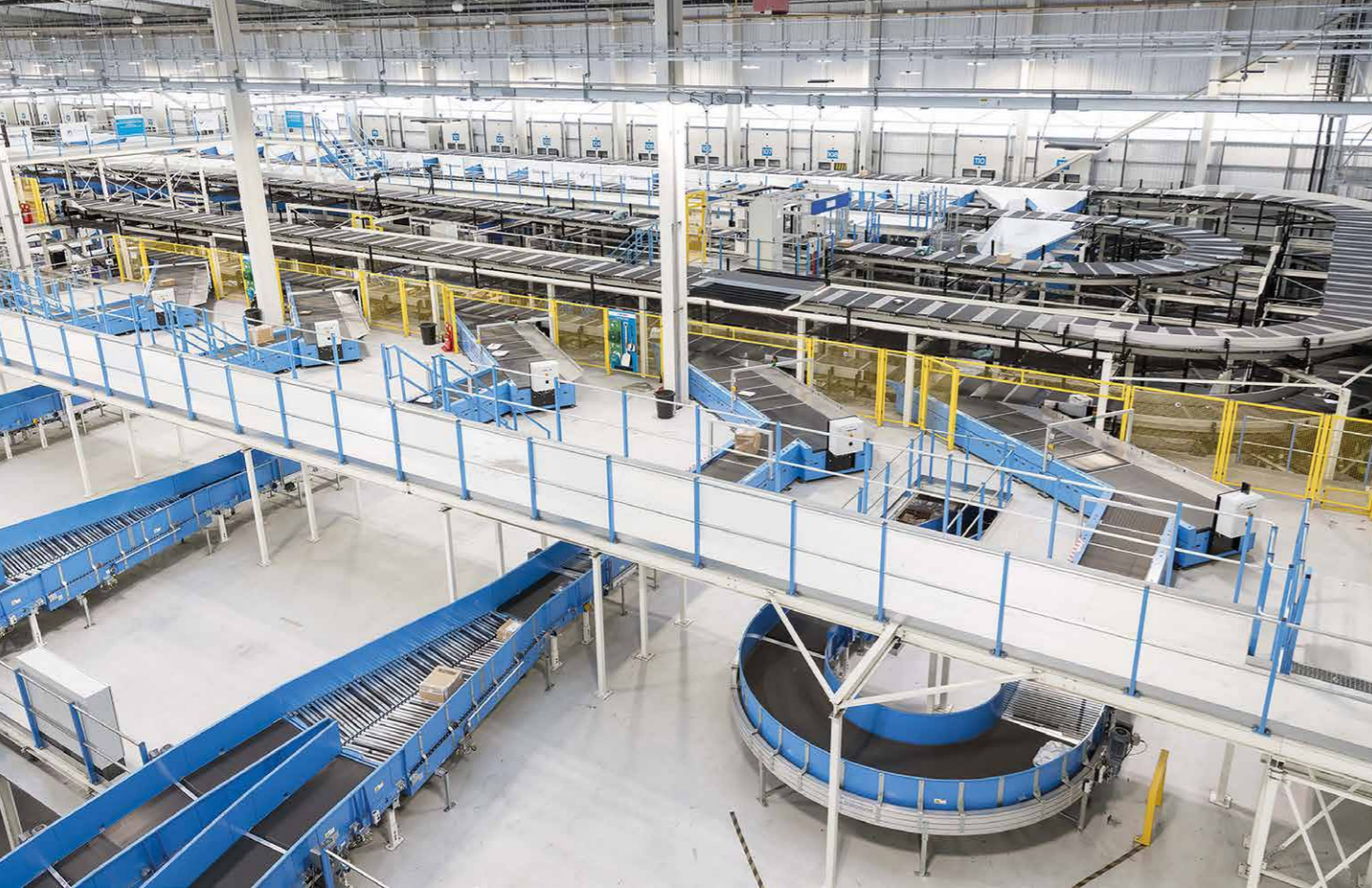
Abbildung 5: Innenansicht eines Hubs 2021 (Sorter der BEUMER Group). Quelle: BEUMER Group GmbH & Co. KG
